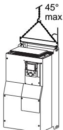
Gli ALTIVAR 71 fino ai calibri ATV71HD15M3X e ATV71HD18N4 possono essere estratti dall'imballaggio e installati senza apparecchi di movimentazione.
